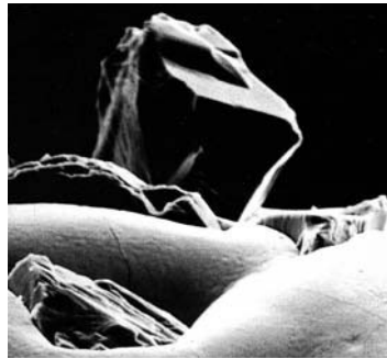
Diamantschleifer: Die Oberflächen von Industriediamanten sind regelmäßiger. Deshalb darf die Körnung ruhig gröber gewählt werden (REM-Aufnahme)
